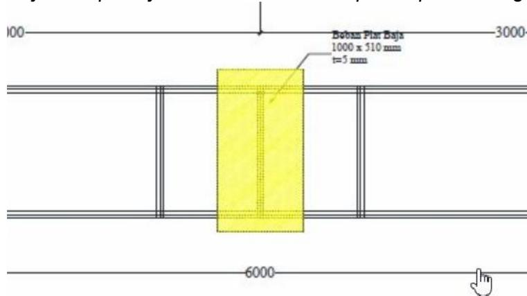
J 2 (dua) dial gage akan ditempatkan di ke 2 tengah bentang rangka batang. Keberadaan Gelagar melintang tergantung kebutuhan peserta dalam rangka pencapaian lendutan yg ditargetkan dan kestabilan rangka yg dibutuhkan utk itu
